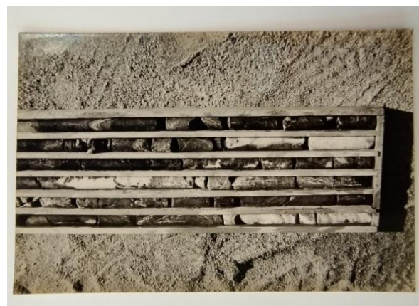
Testemunhos da sondagem de carbonatito na Jazida de Anitápolis/SC. Fotografia: Luiz Fernando Scheibe, 1966.
