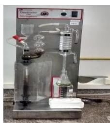
Figura 3 – Destilador de nitrogênio
