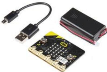
**Figura 1:** Componentes básicos do Micro:bit.
