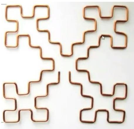
**Figura 11:** Antena interna de celular
